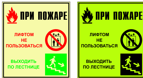
Рис.6 Пример группового знака безопасности для размещения у лифта а) при освещении; б) после отключения освещения
