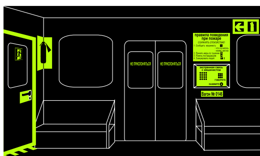
Рис.7 Пример обустройства элементами ФЭС вагона электропоезда после отключения освещения
